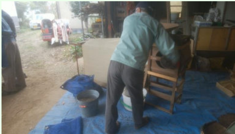
唐箕を使って茎などを除去（その後電動式になりました。）
