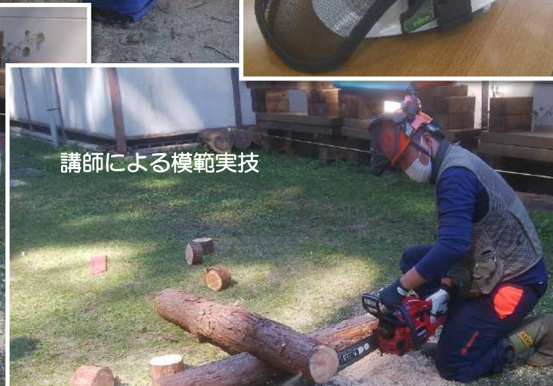
はっとう 伐倒のための 「受け口」切り込み
