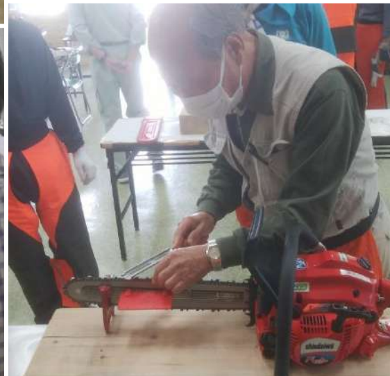
はっとう 伐倒のための 「受け口」切り込み
